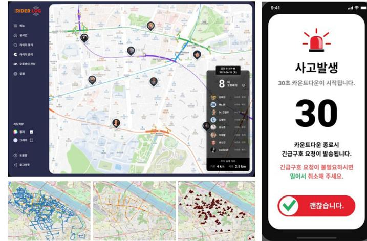
GPS로는 알수 없는 불법, 난폭, 사고 까지 감지할 수 있는 정밀 관제를 실시한다. 이를 통해 개인별 운행 습관을 분석하여 안전도를 측정하고, 이에 맞는 정밀 UBI를 실시할 수 있게 하는 동시에, 안전운전을 유도한다. 또한 위급상황에는 위치정보와 함께 자동으로 구난신호를 발송하여(e-Call), 생명을 구할 수 있도록 한다.
